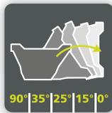
Cada uma das 4 faces do LEDCUBE da HEDI apresenta um ângulo de inclinação diferente. Isto permite que o LEDCUBE seja colocado em cinco posições com ângulos de inclinação de 0 a 90 graus.
