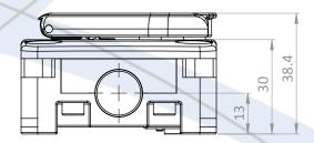
4 Points de fixations pour vis M5 4 Fixing points for screw M5
