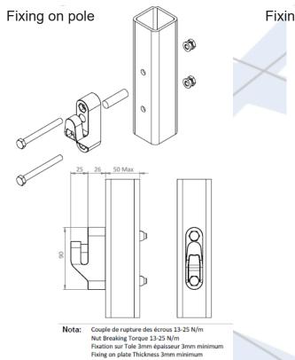
Fixation sur Poteau épaisseur 50mm maxim Fixing on Pole Thickness 50mm maximum
